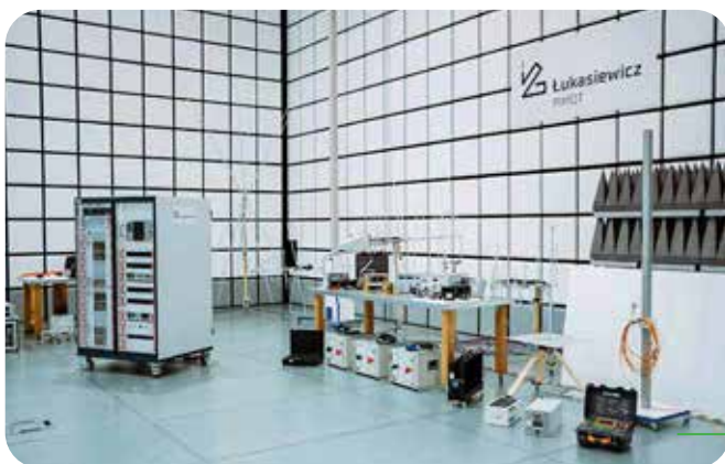
Stano­wisko do badań kom­patybil­ności elek­tro­magne­tycznej – komo­ra EMC
