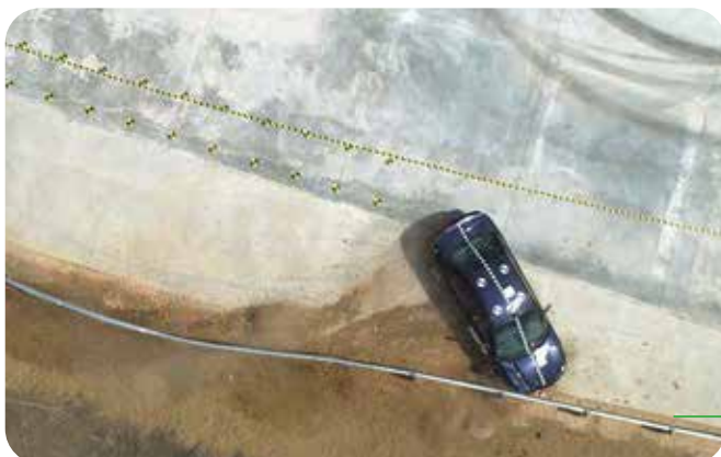
Stano­wisko zder­zenio­we do badań barier i konstrukcji wspor­czych
